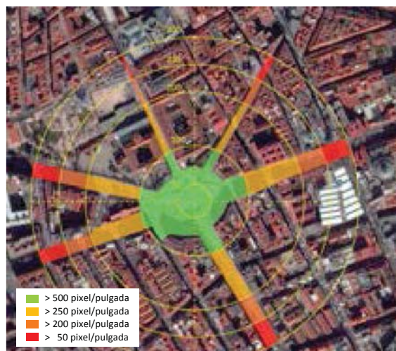
Ejemplo de mapa de resoluciones utilizado en el proyecto para aplicaciones de análisis de imagen
